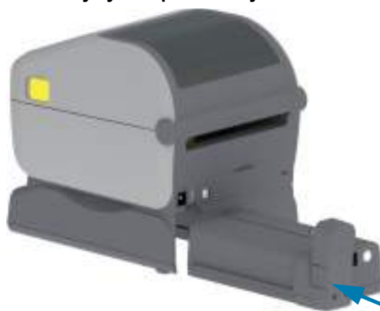
Аккумулятор готов к установке
