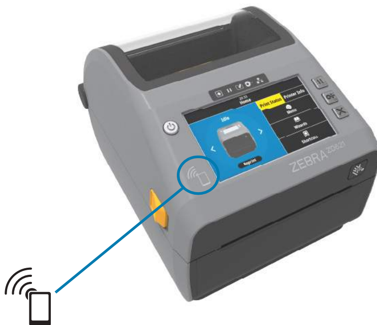
Местоположение эмблемы Print Touch (пассивный элемент NFC)
